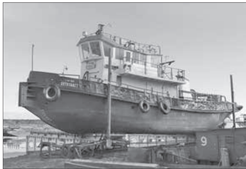
■ Ремонт «Энтузиаста» на слипе РЭБ флота
